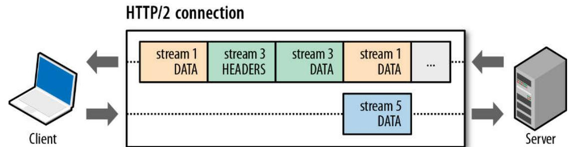
Insgesamt sind drei Streams auf einer Leitung. Die Frames können überlappen und werden am Endpunkt wieder zusammengesetzt.
