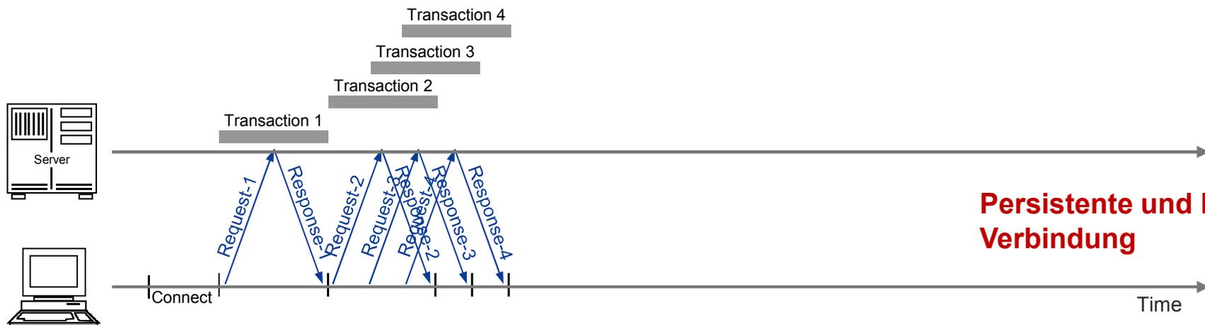
**Persistente und Pipelined Verbindung**
