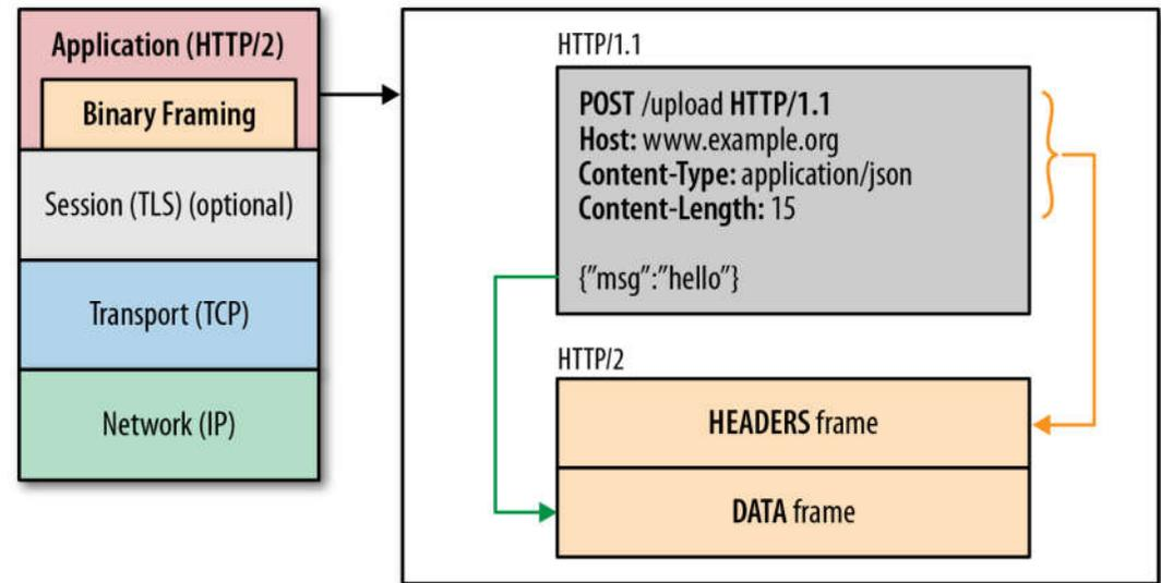
Die HTTP-Struktur wird in zwei Frames gepackt (Message) und diese werden zwischen Client und Server bidirektional verschickt
