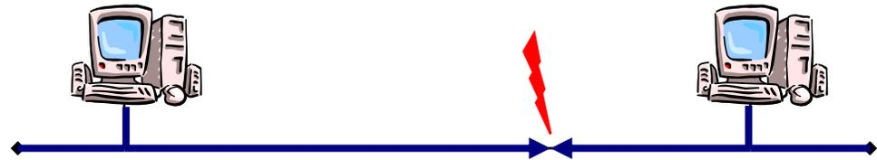
Station B erkennt Kollision, bricht Sendevorgang ab und schickt Jamming-Signal.
