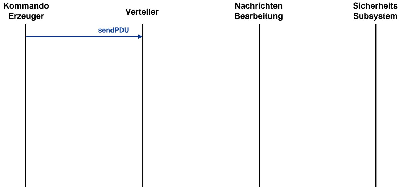
Um eine SNMP Nachricht an eine andere SNMP Einheit (z.B. einen Agenten) zu senden, ruft der Kommandoerzeuger die `sendPDU` Funktion des Verteilers auf und übergibt die zu sendende PDU sowie mehrere Parameter die das gewünschte Nachrichtenformat und Sicherheitsmodell definieren.
