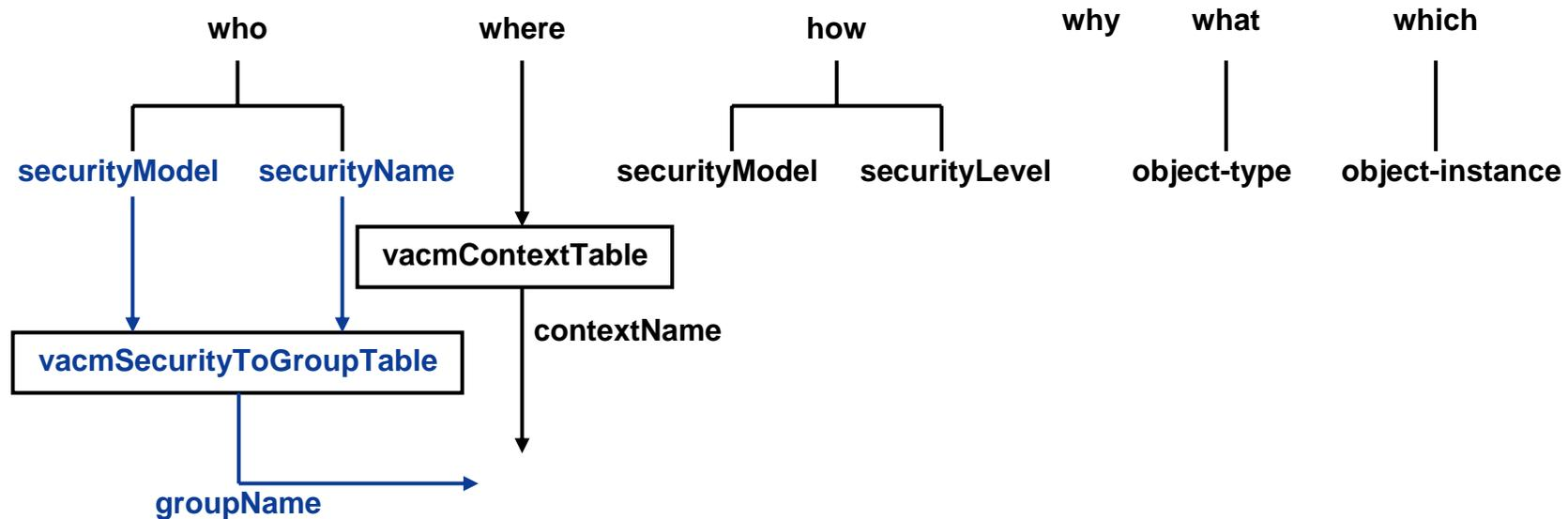
Die Zugriffskontrolle überprüft, ob für die beiden Parameter securityModel und SecurityName ein Eintrag in der vacmSecurityToGroupTable Tabelle vorhanden ist.
