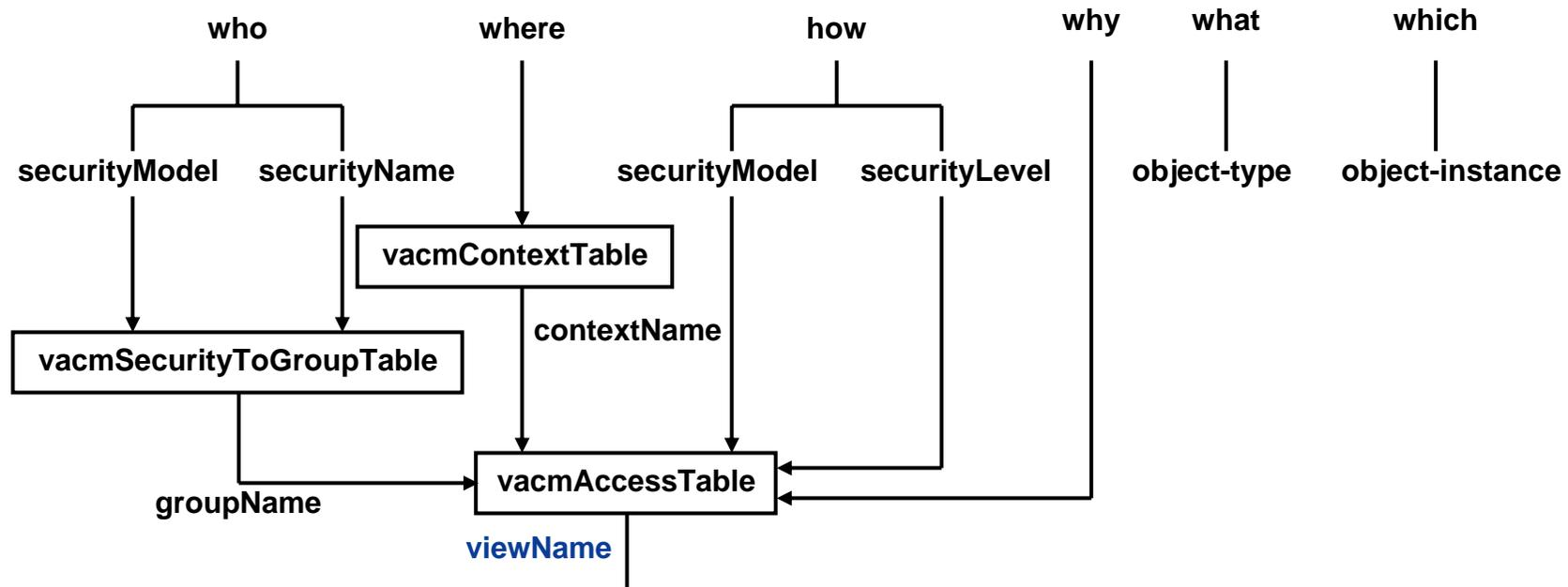
Die Zugriffskontrolle untersucht daraufhin, ob der Eintrag in der `vacmAccessTable` Tabelle eine Referenz auf einen MIB-Sicht vom Typ `viewType` enthält.
