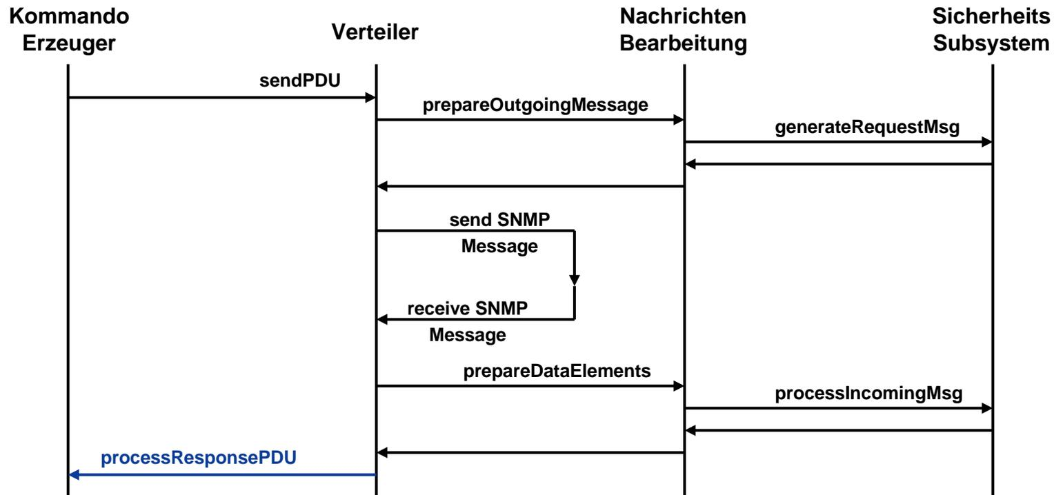
Der Verteiler sendet nun die so gewonnene SNMP PDU an die Kommandoerzeuger Applikation zurück (processResponsePDU), der die Antwort PDU entsp. bearbeitet.
