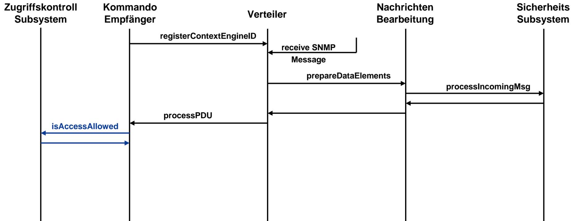
Der Kommandoempfänger überprüft zunächst, ob der Zugriff erlaubt ist, indem er die `isAccessAllowed` Funktion des Zugriffskontrollsubsystems aufruft.
