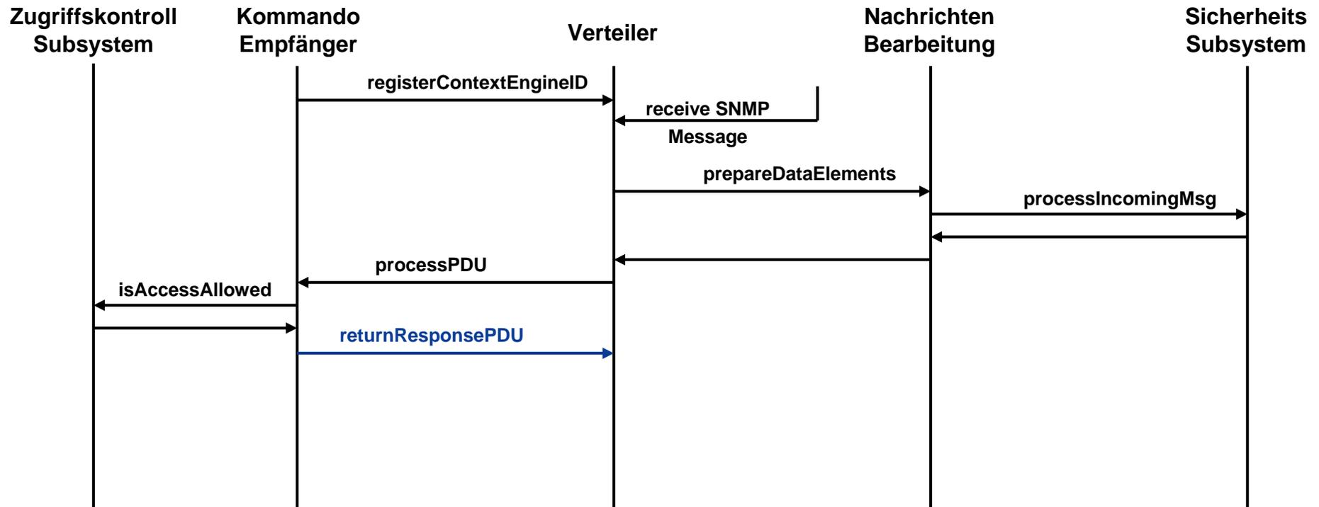
Ist der Zugriff erlaubt, so bearbeitet der Kommandoempfänger die PDU entsprechend, generiert eine Antwort PDU und sendet diese an den Verteiler zurück (returnResponsePDU).
