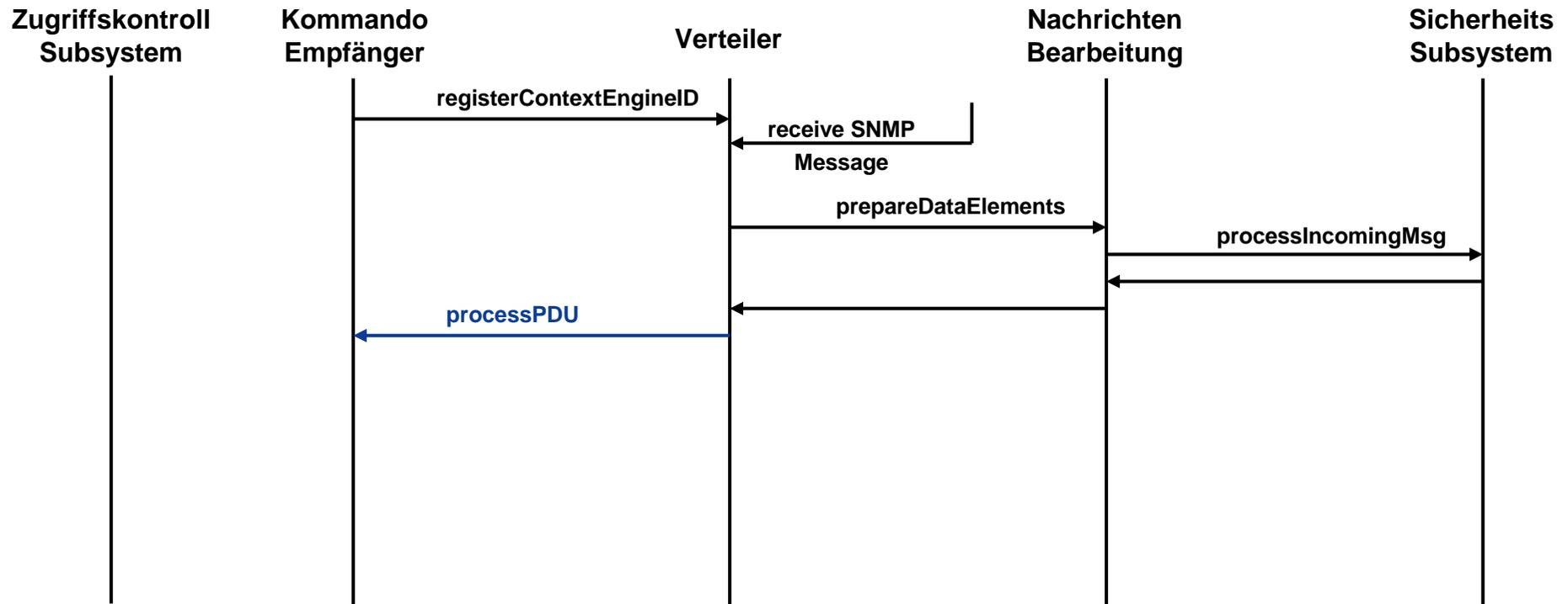
Der Verteiler ruf daraufhin die Funktion processPDU des Kommandoempfängers.
