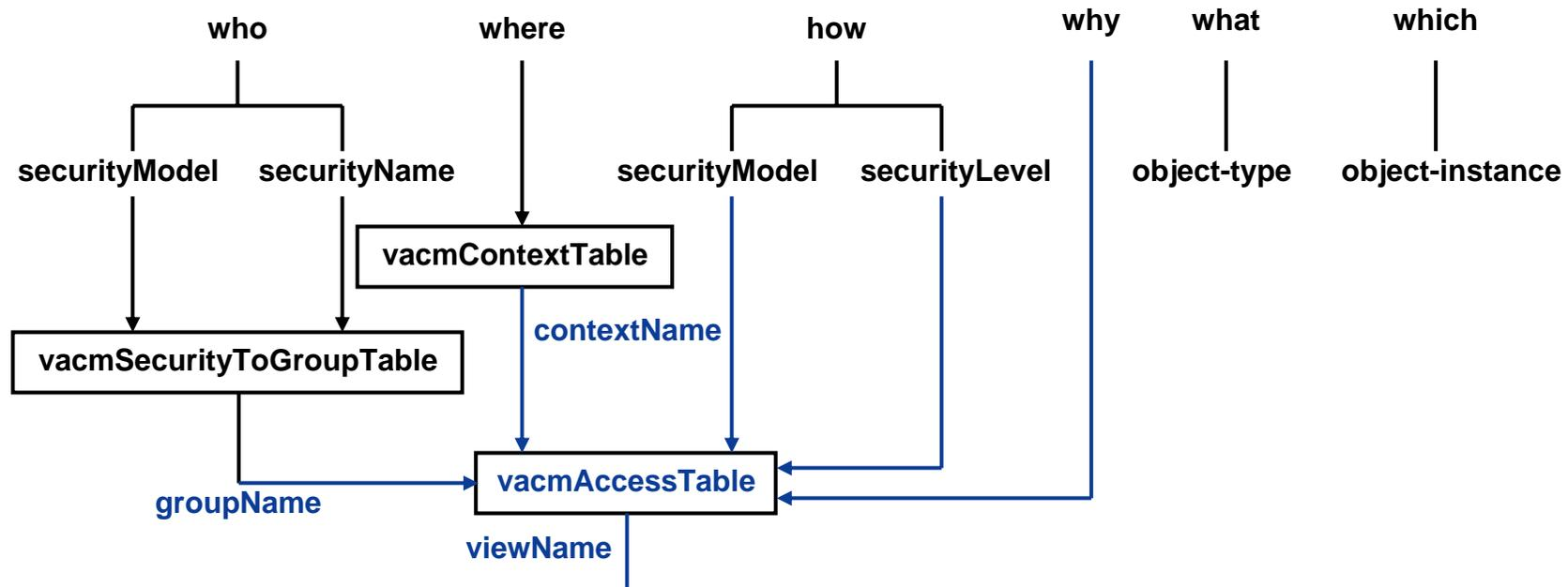
Die Zugriffskontrolle überprüft die Tabelle `vacmAccessTable` mit den Parametern `groupName`, `contextName`, `securityModel` und `securityLevel`.
