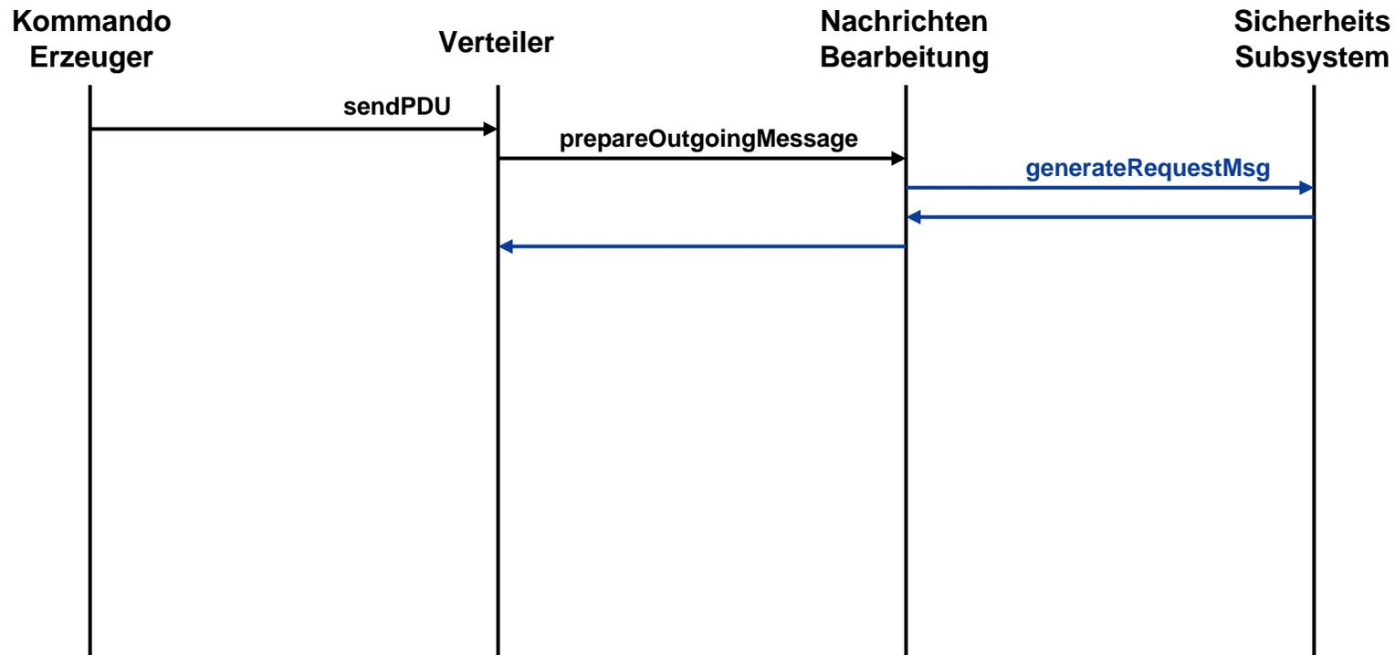
Falls Authentifizierung oder Verschlüsselung erforderlich ist, wird die SNMP Nachricht an das Sicherheitssystem weitergeleitet (`generateRequestMsg`).
