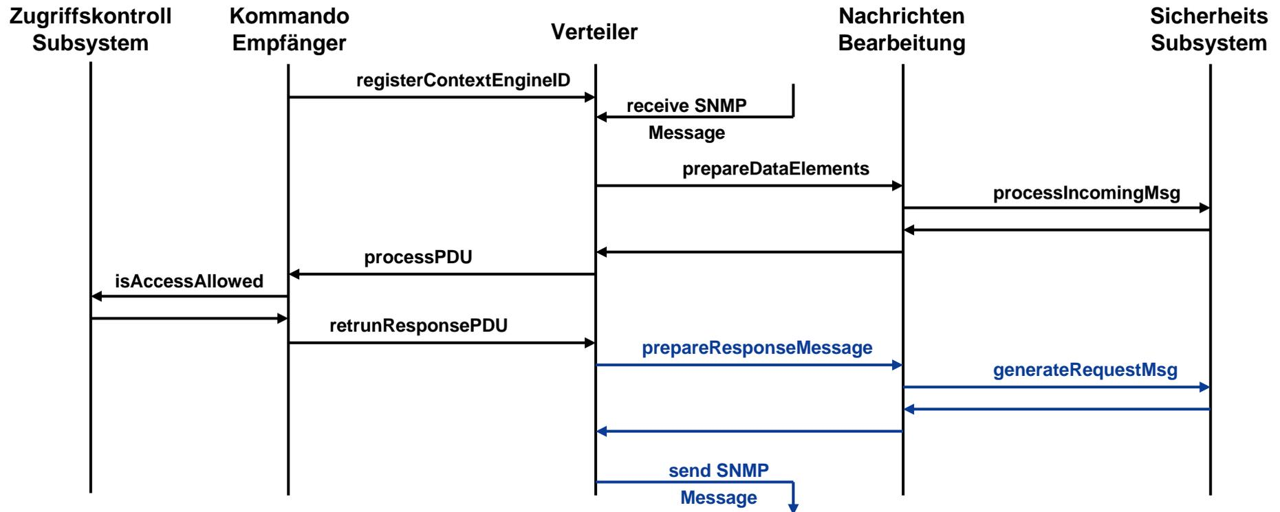
Die Antwort PDU wird dann vom Verteiler an das Nachrichtensubsystem weitergesendet (prepareResponseMessage), das eventuell mit Hilfe des Sicherheitssubsystems eine SNMP Nachricht daraus generiert und an den Verteiler zurückgibt.
