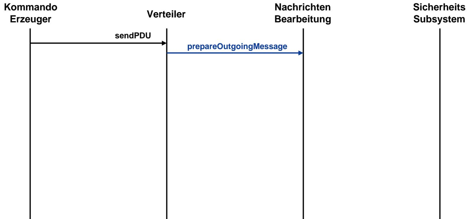
Der Verteiler leitet daraufhin die SNMP PDU an das entsp. Bearbeitungsmodul (für SNMPv1/v2/v3) weiter (prepareOutgoingMessage).
