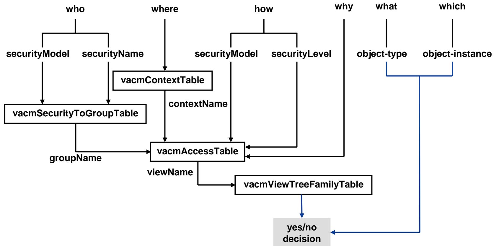
Im letzten Schritt überprüft die Zugriffskontrolle, ob die Objektinstance `variableName` in der gefundenen View enthalten ist.
