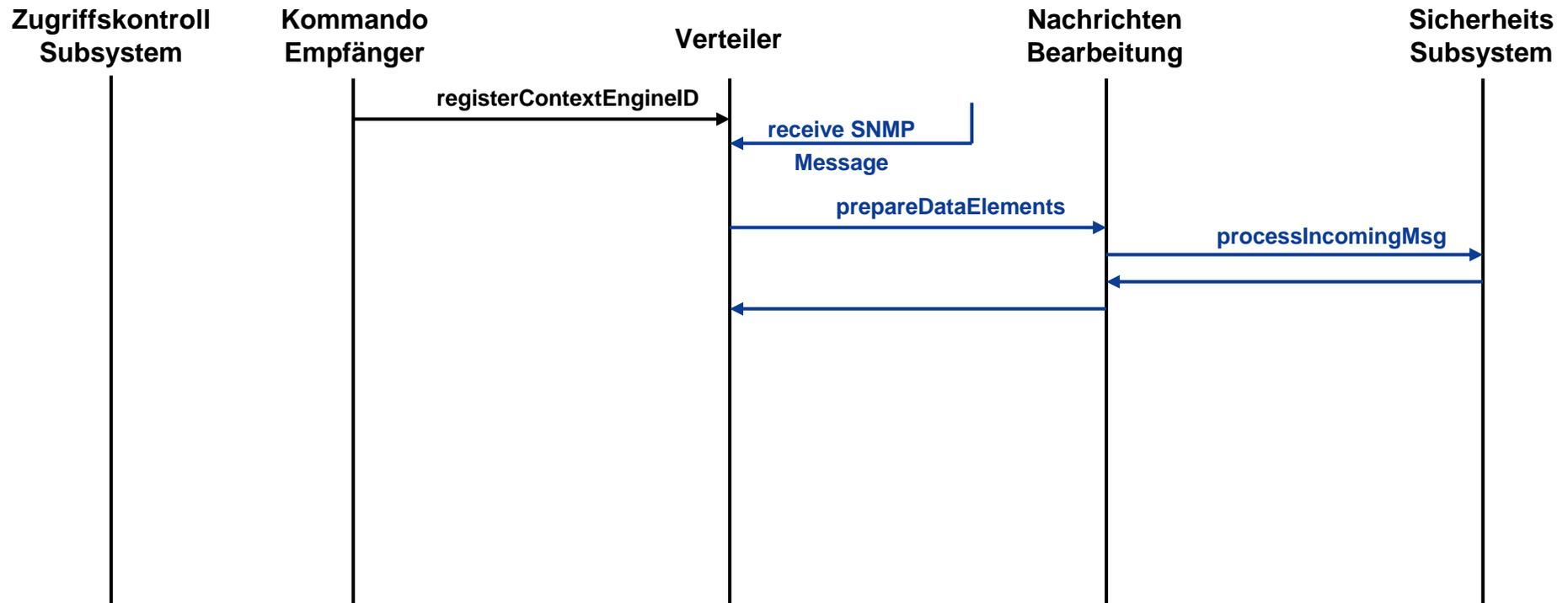
Empfängt der Verteiler eine SNMP Nachricht, so wird daraus mit Hilfe der anderen Subsysteme die SNMP PDU extrahiert.
