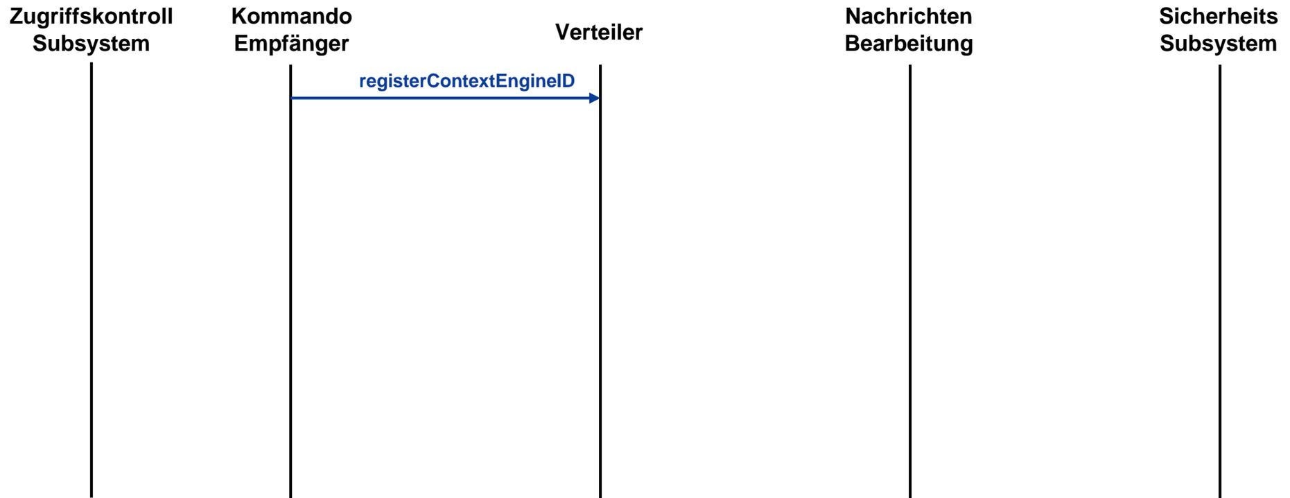
Bevor ein Kommandoempfänger SNMP PDUs vom Verteiler zugewiesen bekommt, muss er sich zunächst beim Verteiler dafür mit seiner SNMP *EngineID* anmelden (`registerContextEngineID`).
