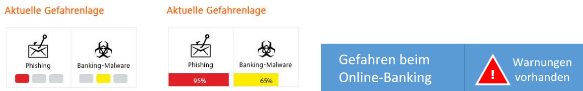
Abbildung 4 - Detaildarstellung der Gefahrenmeldung als kategoriales Ampel-System (Links), kontinuierliches Ampel-System (Mitte) und ein Info-System mit aktueller Gefahrenmeldung (Rechts)
